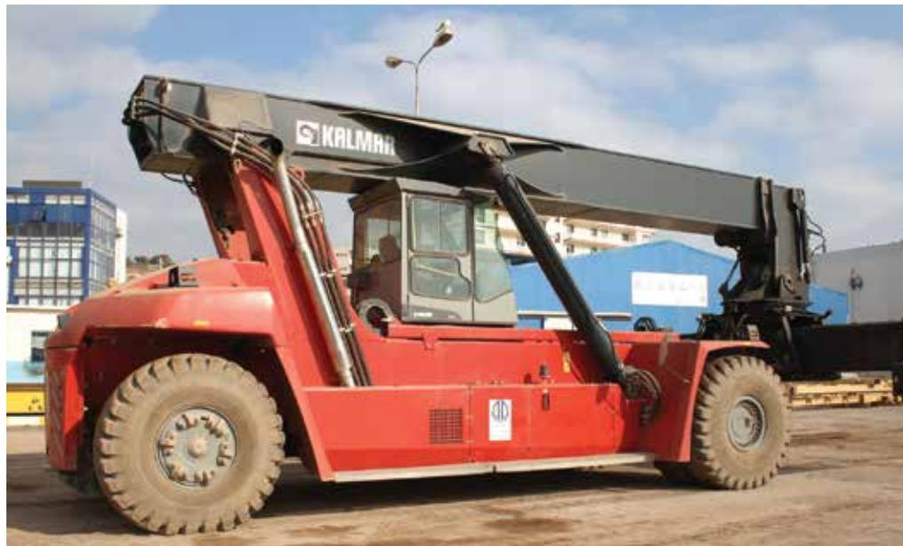
**Un chariot élévateur : à spreader extensible sur mat télescopique à deux éléments avec une capacité de levage de 9 T. Prise frontale par twislock, destiné au gerbage de conteneurs vides de 20 à 40 pieds**
