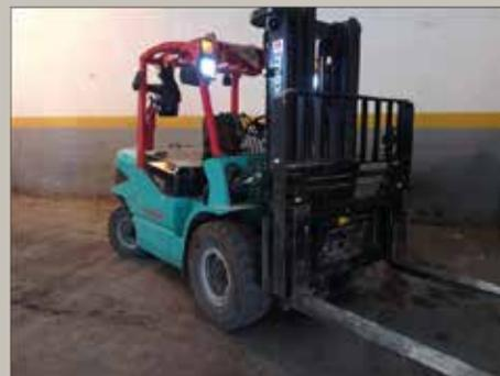
3 - Chariot élévateur à fourche, à translation latérale, à mât triplex conçu pour la manipulation de diverses marchandises, de marque HYSTER-MAXIMAL, modèle FD50T-M1WI3
